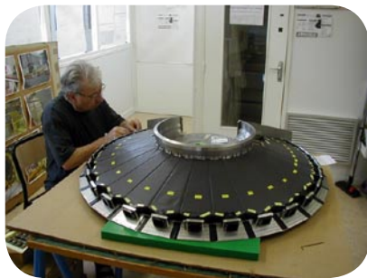
Figure 11 : Montage d'une des 2 couches de scintillateurs pour n-DVCS à JLab.
