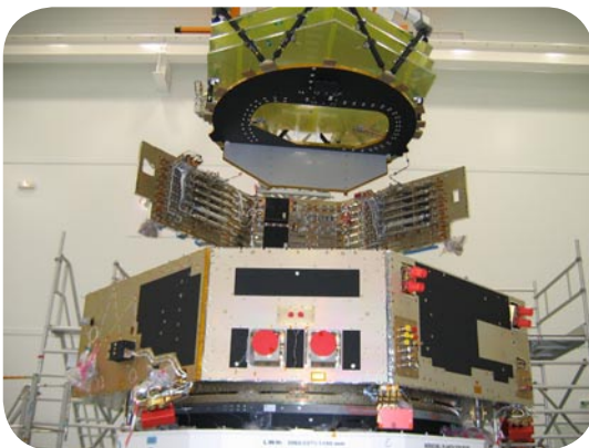
Figure 18: Les cryo-générateurs et leur électronique en cour d'intégration sur le satellite Planck.
