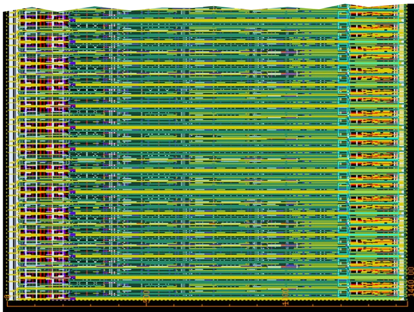
Figure 11: Vue de quelques uns des 50 canaux ADC pipeline de 5 bits pour pixel MOS.
