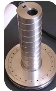
Figure 12: Chambre à plasma avec hélice de refroidissement.
