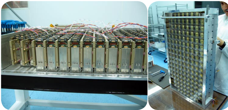
Figure 1: Module du détecteur Cherenkov d'AMS avec PM multianodes.
