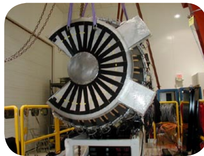
Figure 12 : Montage du tagger sur le détecteur.
