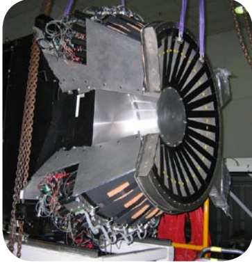
Figure 8 : Le détecteur est fermé d'un côté par une tôle roulée en 304L et de l'autre par une tôle en AGS roulée en cône.
