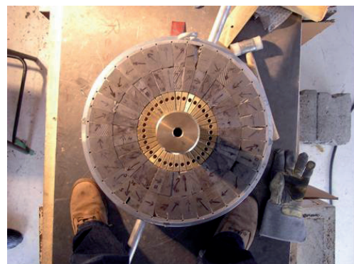
Figure 13 : hexapôle d'A-PHOENIX rempli avec ses aimants permanents.
