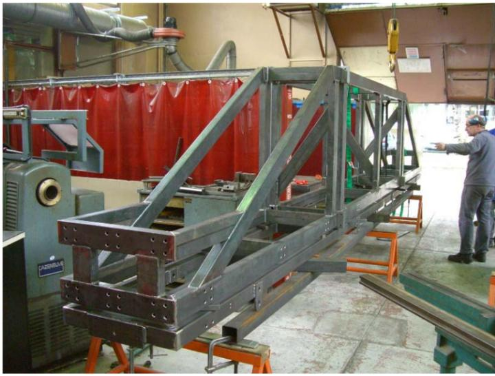
Bel ouvrage de chaudronnerie pour cette table d'insertion/extraction de plus de 7,5 m dans l'atelier du LPSC
