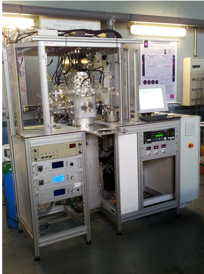
Fig. 1 : Réacteur de gravure et de dépôt PECVD équipé de 25 coupleurs d'onde (sources plasma unitaires).
