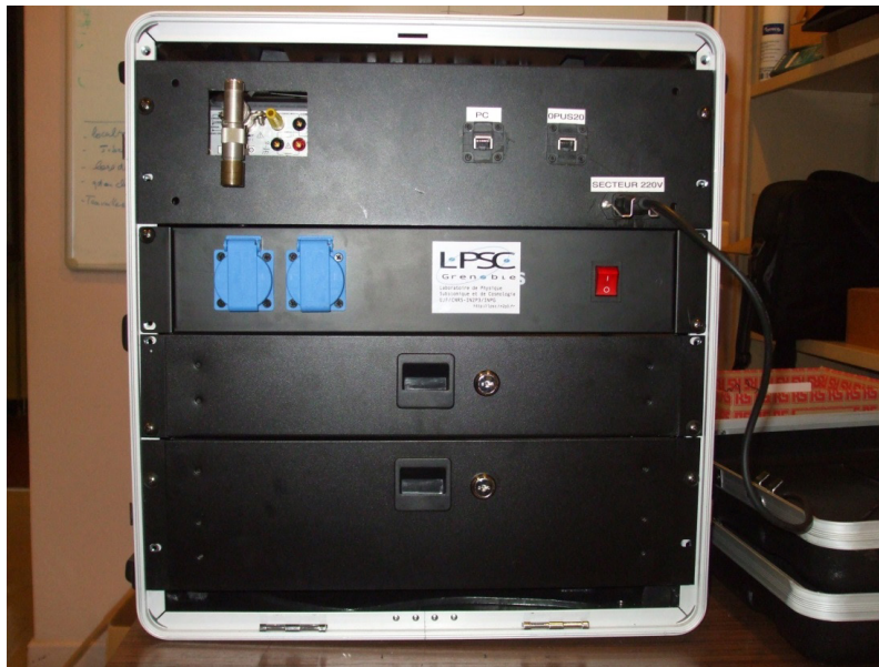
Fig. 1 : Vue d'ensemble de la baie de mesure de courant faible produite par le SDI.
