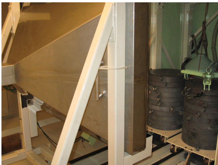
Fig. 1 : Vue du dispositif de mesure entrouvert : les 2 châteaux de plomb protégeant les détecteurs sont visibles à l'intérieur des véto cosmiques.
