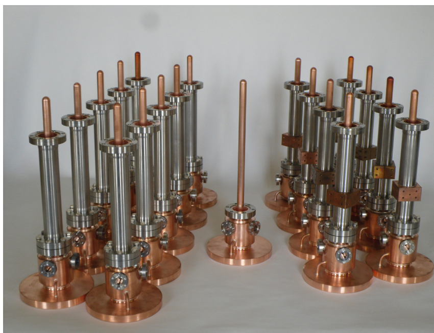
Fig. 3 : Série des coupleurs RF de puissance pour le linac de SPIRAL2.
