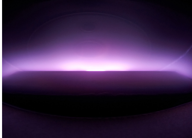
Fig. 1 : Plasma d'argon (Ar, 5 Torr) obtenu par une source micro-onde élémentaire à 352 MHz pour une puissance de 70 W.
