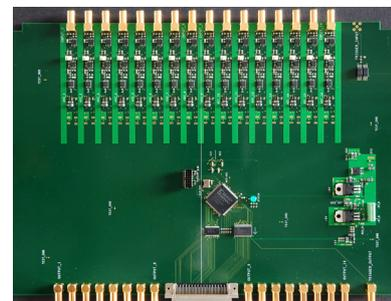
*Fig. 4: Carte d'électronique d'amplification et de numérisation des charges développée pour le suivi en ligne des signaux à la sortie des électrodes du 3<sup>e</sup> prototype.*
