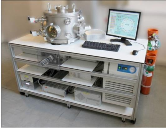
La machine de dépôt MBS-20 (Fig. ci-contre), fabriquée grâce à un financement GRAVIT en 2011, contient 20 sources d'ions COMIC et peut faire des dépôts d'épaisseur homogène sur de très grandes surfaces. Ces 20 sources peuvent tirer 20 faisceaux d'ions indépendants sur 20 matériaux cibles fixés sur un porte-cible. Dans ce cas c'est une zone de 200 à 300 mm de diamètre qui peut subir le dépôt. Avec l'aide de l'Institut Néel qui nous a permis d'utiliser tout son
