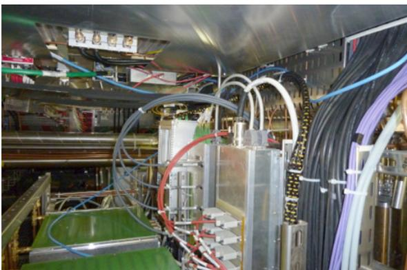
Fig. 2: Le point de connexion PP2 (Patch Panel 2).
