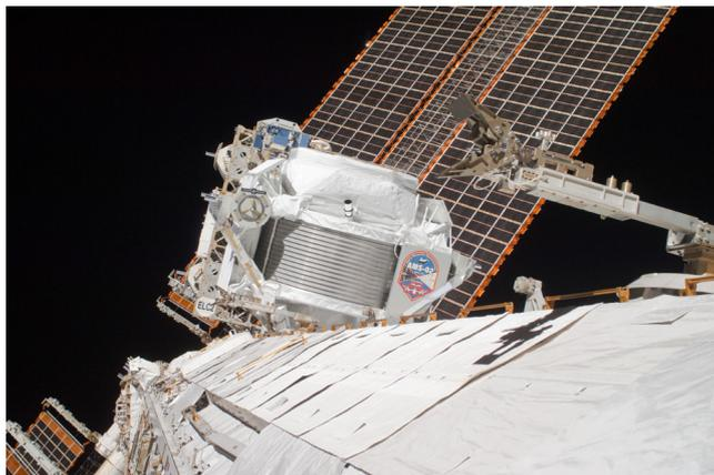
Fig. 1 : Détecteur AMS-02 installé sur la station spatiale.
