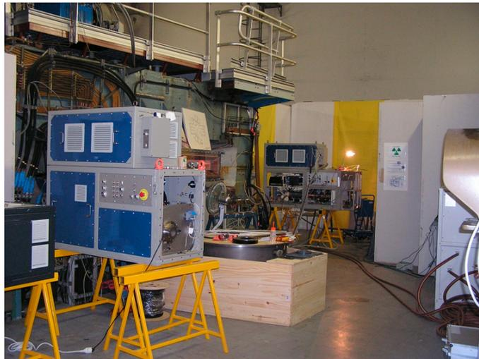
Fig. 1 : Accélérateurs linéaires à électrons en tests dans la casemate du cyclotron SARA.
