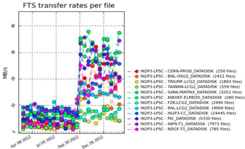
Fig. 2: Évolution des taux de transfert du LPSC vers les Tier-1 d'ATLAS, mesuré par ATLAS pour des fichiers de plus de 1 Go, au moment du passage à 5 Gbits/s.
