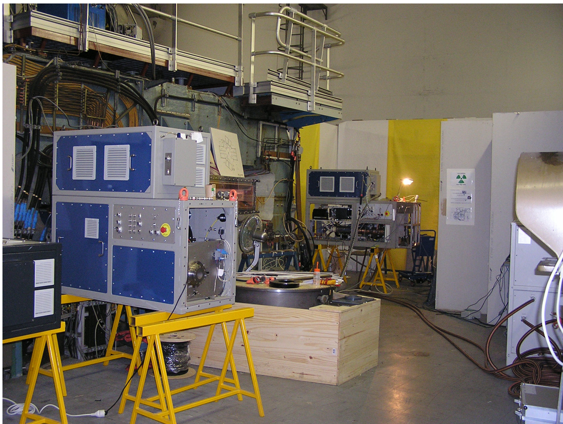
Figure 1 : Accélérateurs linéaires à électrons en tests dans la casemate du cyclotron SARA.
