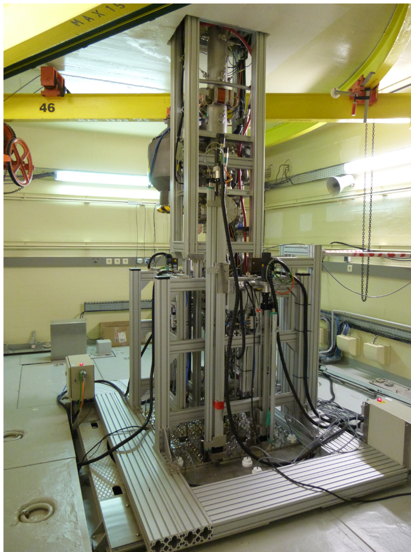
Figure 1 : Partie terminale de la ligne de faisceau de GENEPI-3C insérée dans le réacteur VENUS-F.
