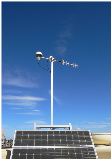
Fig. 2: Gauche : une antenne EASIER (en haut, sur la gauche du mat) sensible dans le GHz, montée en vis à vis de l'antenne Yaggi assurant la communication des données du WCD. Droite : en haut, signal de l'antenne GHz et signal saturé de l'anode (bas gain) des PM 1 et 2 du WCD; en bas, puissance reçue par l'antenne GHz en pico watt après étalonnage.
