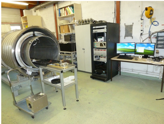
Fig. 3: Vue du blindage de l'expérience de recherche de nouvelle force avec l' ^3\text{He} polarisé dans son emplacement définitif. L'extrémité du solénoïde générant le champ magnétique est aussi visible.
