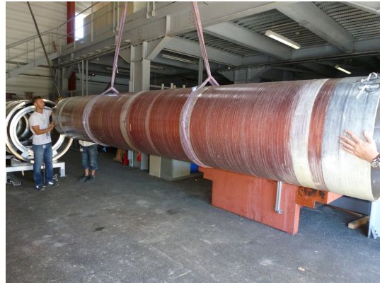
Fig. 2: Installation du solénoïde dans le blindage.
