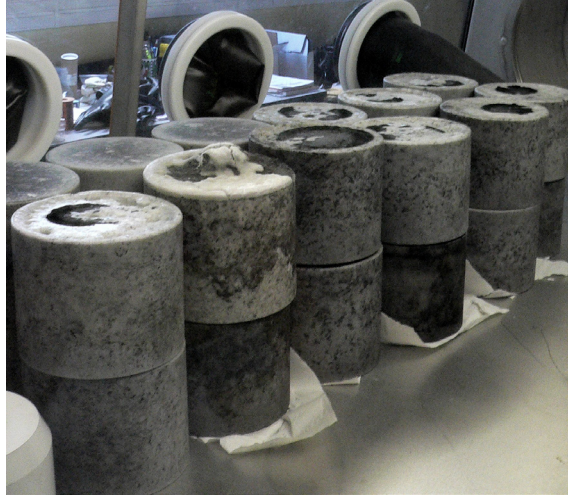
Fig. 2: Vue des 24 lingots du mélange eutectique LiF-NaF-KF conservés dans la boîte à gant de stockage avant leur transfert dans le réservoir de la boucle où ils ont été refondu en un seul bloc.
