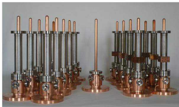
Fig. 3: Coupleurs RF de puissance pour le projet SPIRAL2.
