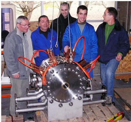
Fig. 1: Source d'ions ECR à 60 GHz assemblée.
