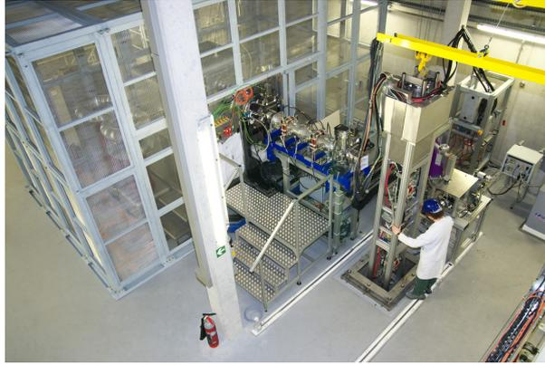
*Fig. 1: L'accélérateur GENEPI-3C sur le site du SCK•CEN (Belgique) au niveau supérieur pendant l'insertion de la ligne verticale de faisceau dans la casemate du réacteur.*
