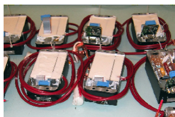
Fig. 3: Un des modules d'alimentation 12 kV spécifiquement développés pour fonctionner dans une atmosphère à faible pression résiduelle.
