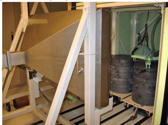
Fig. 1 : Vue du dispositif de mesure entrouvert ; sur la gauche le nouveau détecteur de muons et son cône de collection de lumière.
