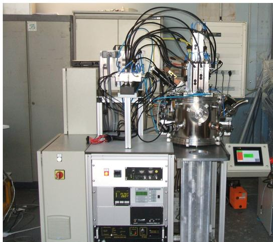
Fig. 1: Exemple de réacteur équipé de sources plasma micro-onde et commercialisé par Boréal. Ce réacteur, développé dans le cadre du projet ANR-Plasmodie, est utilisé depuis 2010 au LSPM pour le dépôt de diamant polycristallin à basse pression.
