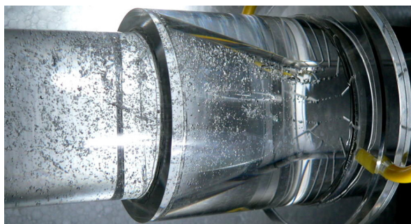
Fig. 1: Injection de bulles dans la boucle en eau, au niveau d'un Venturi situé dans une portion horizontale du circuit.
