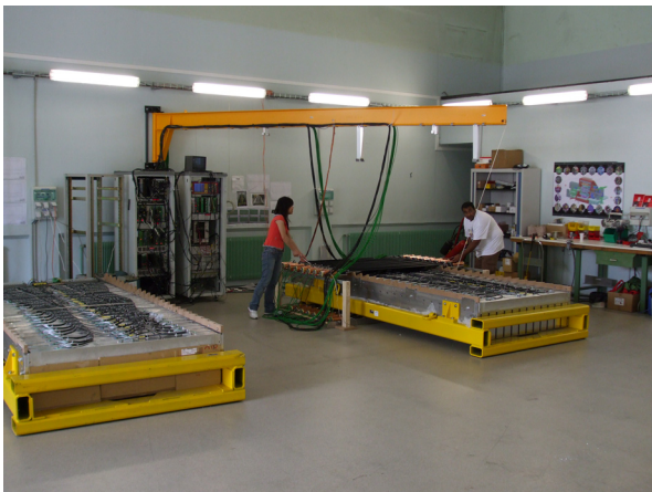
Fig. 1: Assemblage, test et calibration des premiers supermodules réalisée au sein du hall ARIANE du LPSC.
