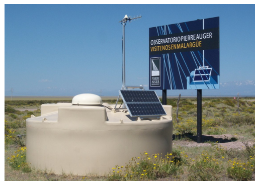
Fig. 1: Un des 1600 détecteurs de surface de l'Observatoire Pierre Auger, dans la pampa argentine.
