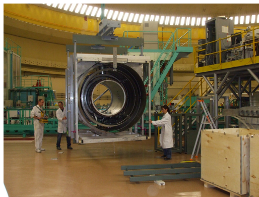
Fig. 2 : Démontage de l'ensemble blindage+chambre à vide du spectromètre RAL-Sussex avant emballage et transport vers le PSI.
