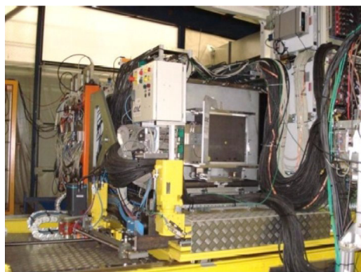
Fig. 1: Dispositif testé à Fermilab (USA), au centre: le prototype de calorimètre EM (~ 10000 voies) suivi par le prototype de calorimètre hadronique analogique.
