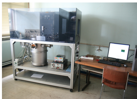
Photo 3: Ensemble de l'IMF dans son enceinte pour des tests d'irradiations et de dépôts jusqu'à 40 cm de diamètre.
