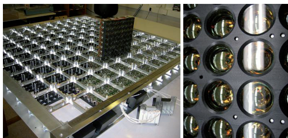
Figures 14 et 15 : Structure mécanique intégration des cartes, et PM du détecteur CHERCAM.
