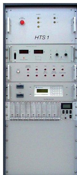
Baie comprenant l'alimentation des bobines supraconductrices et l'électronique « anti-quench » (en bas).
