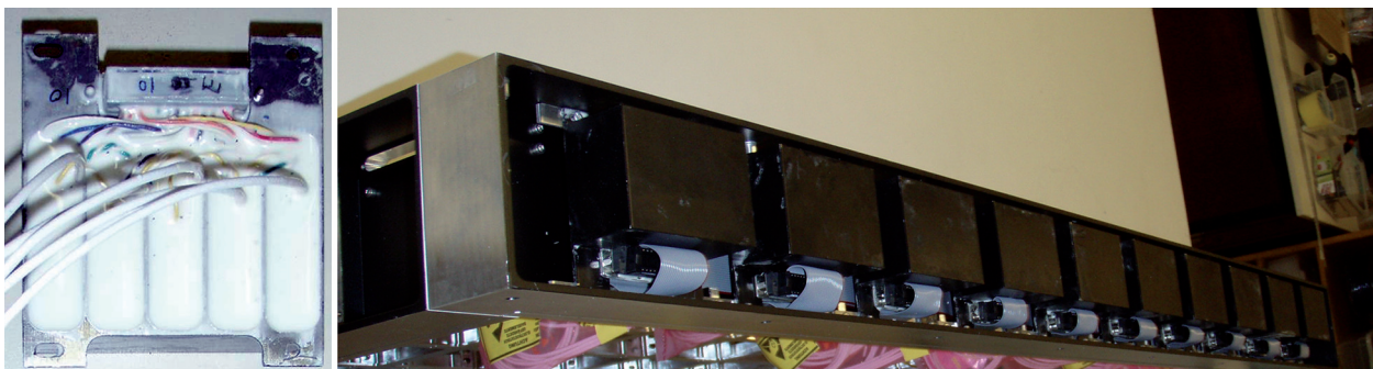
Modules haute tension « pottés » et intégrés sur le détecteur.
