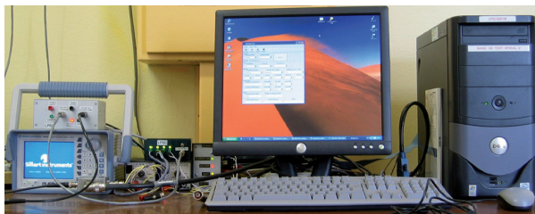
Partie contrôle du banc de test SPIRAL 2 (PC, générateur RF, générateur d'impulsions, modulateur et watchdog).
