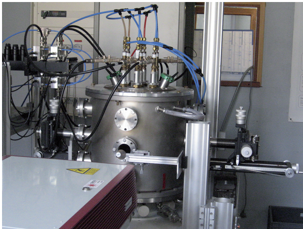
Figure 4: Photo de la source d'ions H^- et du laser Nd-Yag pour les diagnostics par photodétachement.
