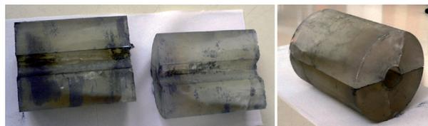
Figure 13 : Lingot creux en  $\text{Li}^7\text{F}$  en deux parties réalisées successivement en moule en graphite.
