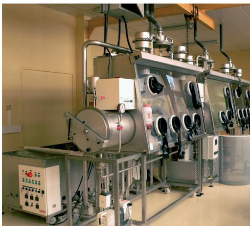
Figure 12 : Ensemble des trois boîtes à gants associées de la plateforme PEREN Chimie.
