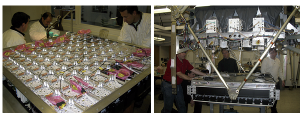
Détecteur CHERCAM en cours d'intégration (décembre 2006, LPSC) et intégration dans CREAM, et Ensemble de l'instrument CREAM III intégré (U.Maryland, College Park, janvier 2007).
