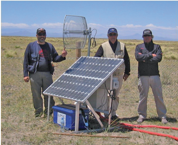
Photo 1 : Station autonome permettant le déclenchement et l'acquisition de données d'un réseau d'antennes radio sur le site d'Auger.
