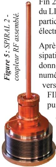
Fin 2004 la phase d'avant-projet détaillé des coupleurs RF des cavités accélératrices supraconductrices du LINAC de SPIRAL 2, auquel le SERM a fortement contribué s'est achevée. Ces coupleurs doivent en particulier répondre à des exigences de couplage électromagnétique et de dissipation thermique.
