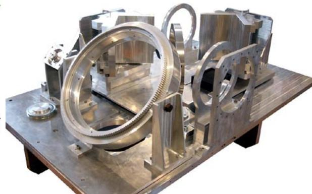
**Figure 11:** Interféromètre Martin-Puplett en cours de montage.
