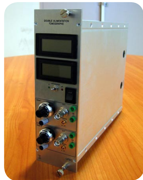
Figure 5 : Double alimentation HT pour APD.
