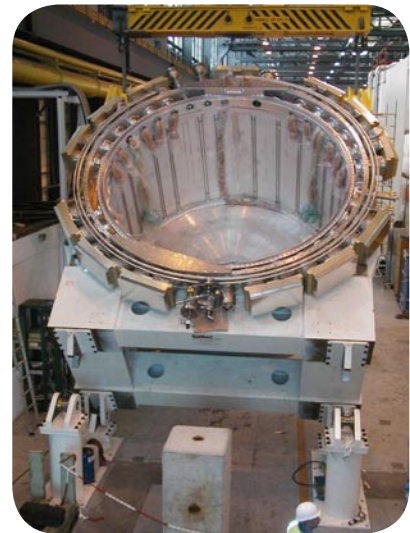
Figure 1 : End-Cap C au hall 180 avant intégration des détecteurs et installation des équipements cryogéniques pour les tests en froid.
