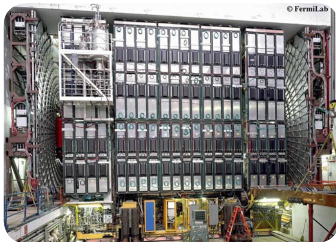
Figure 1: L'expérience DØ: vue générale du détecteur (au premier plan: les scintillateurs des détecteurs de muons) lors de sa mise en place en vue du Run II. Le détecteur mesure environ 10 m de hauteur.
