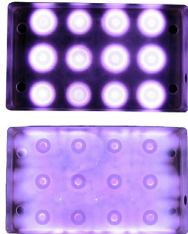
Figure 7: Photos d'un plasma matriciel d'argon vu de face :
