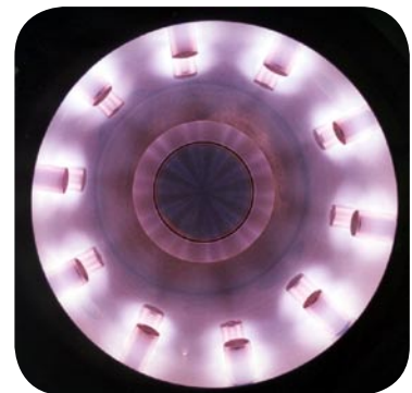
Figure 4: Plasma d'argon dans un réacteur multi-dipolaire cylindrique.
