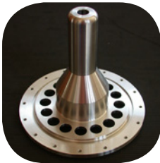
Figure 3 : Électrode de la source Micro PHOENIX réalisée à l'atelier du SERM.
