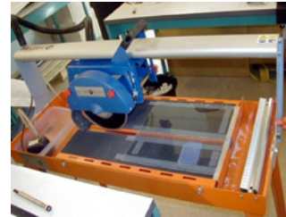
Figure 10 : Machine mise au point pour la découpe des plaques d'aérogel.
