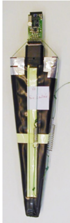
Figure 13 : Premier prototype de scintillateur pour l'expérience n-DVCS, Ne111 habillé d'aluminium, Pm Hamamatsu R7877 en contact avec le scintillateur (gel DowCorning), pont LPC Clermont, coque de centrage AMS modifiée.
