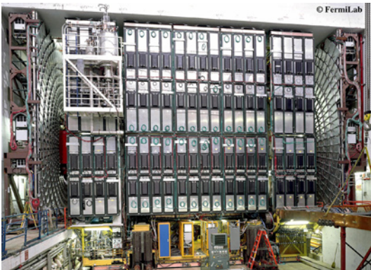
Figure 1 : Vue latérale du détecteur DØ lors de sa mise en place dans le hall expérimental. Le détecteur mesure environ 10 m de hauteur.
