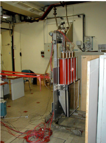
Figure 4 : Détecteur Čerenkov pour les mesures aux angles arrières.
