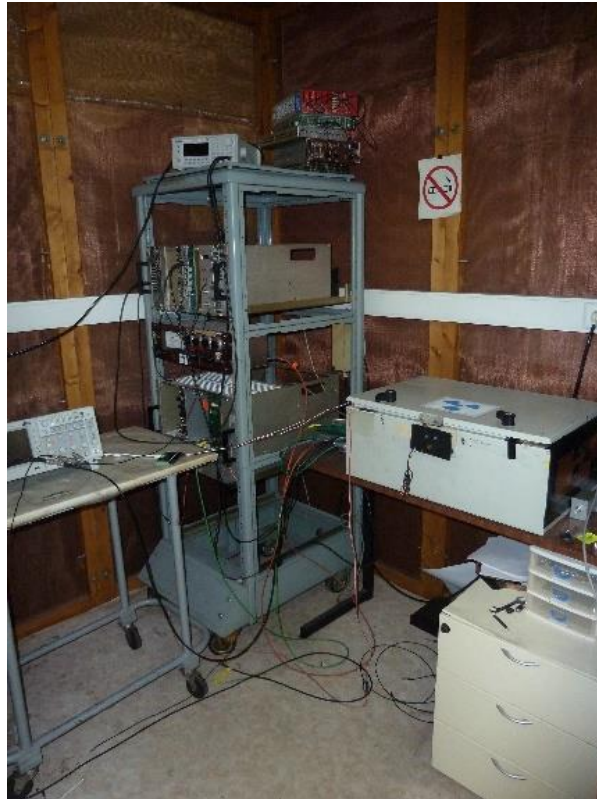
Figure 7 : dispositif de test sous irradiation beta dans la cage de Faraday.
