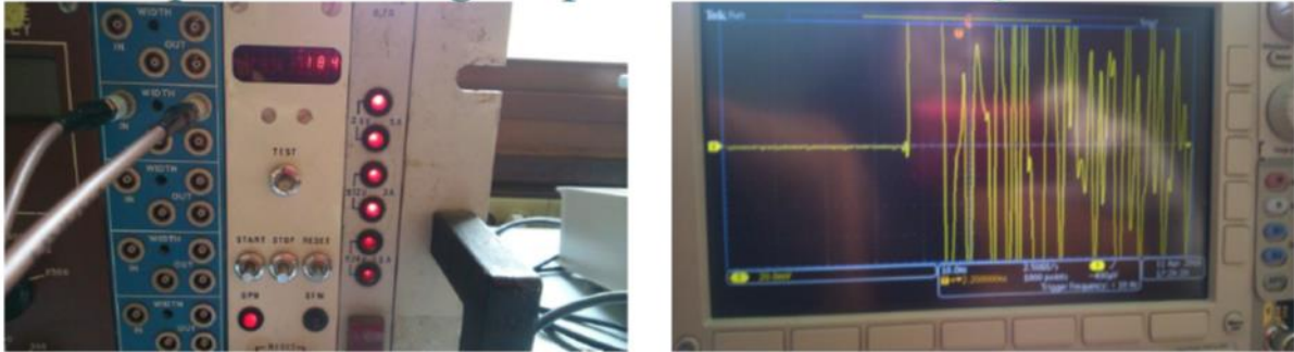
Figure 9 : Observation de phénomènes de claquage : dispositif de tests de la métallisation
