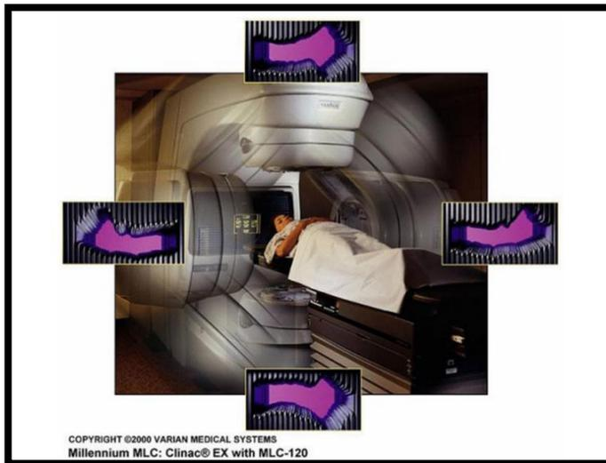
*Figure 7 : Représentation des différentes formes du collimateur multi-lames associées à différents angles de vues de la tumeur par la machine*
