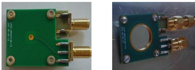
*Figure 20 : Détecteurs diamants montés sur support (gauche : diamant de 5 mm de côté et de partie sensible effective de 2 mm de diamètre limitée par le porte échantillon, droite : diamant de 20 mm de côté et de partie sensible effective de 16 mm de diamètre)*
