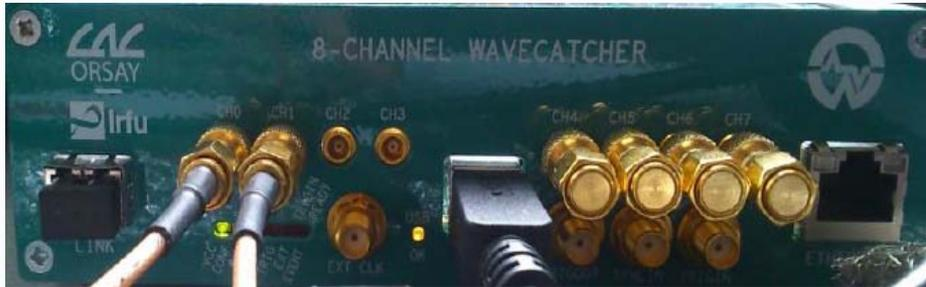
Système d'acquisition WaveCatcher
