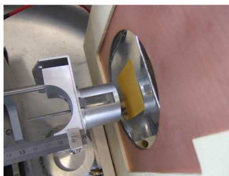
FIG. H.5 – Utilisation d'une pointe pour connaître la position exacte de la cible.
