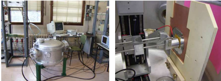
FIG. H.4 – A gauche, vue d'ensemble du dispositif expérimental. On y distingue au centre, l'enceinte fermée ainsi que le PC d'acquisition. A droite, vue du système de détection à l'intérieur de l'enceinte. On peut y voir l'ensemble “collimateur - jonction silicium” installé pour la cartographie. Cet ensemble est situé à quelques millimètres seulement de la cible.
