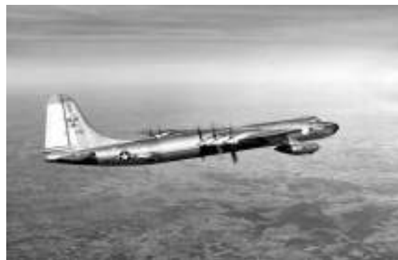
FIGURE 2.3 – NB-36H en vol. Un marquage sur la queue de l'appareil indique la présence du réacteur nucléaire à bord. (photo U.S. Air Force)
