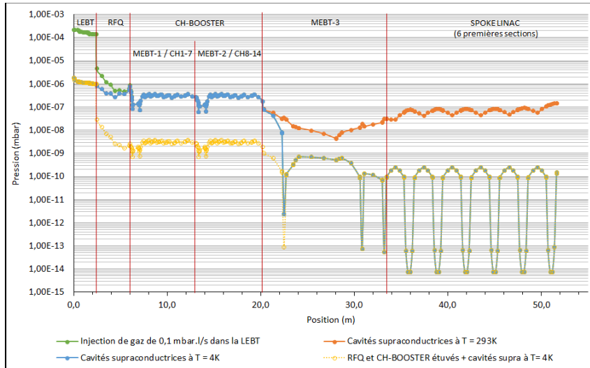
Figure 4 : Courbes de pression au long de l'accélérateur MYRRHA 100 MeV
